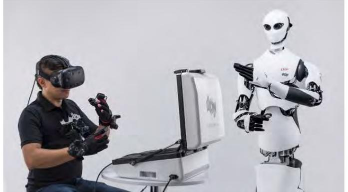
2018年5月29日にKDDIとTelexistenceにより発表された遠隔操作ロボットの量産型プロトタイプ「MODEL H」。視聴覚や触覚を伝送するテレプレゼンス技術、VR(仮想現実)技術、通信技術やクラウド技術が活用されている。
